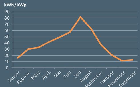
Die in den beiden Diagrammen dargestellten Kurvenverläufe zeigen die jeweiligen Photovoltaik-Ertragswerte (normiert auf kWh/kWp) für die Ausrichtungen nach Süden (oben) und Osten (unten).
